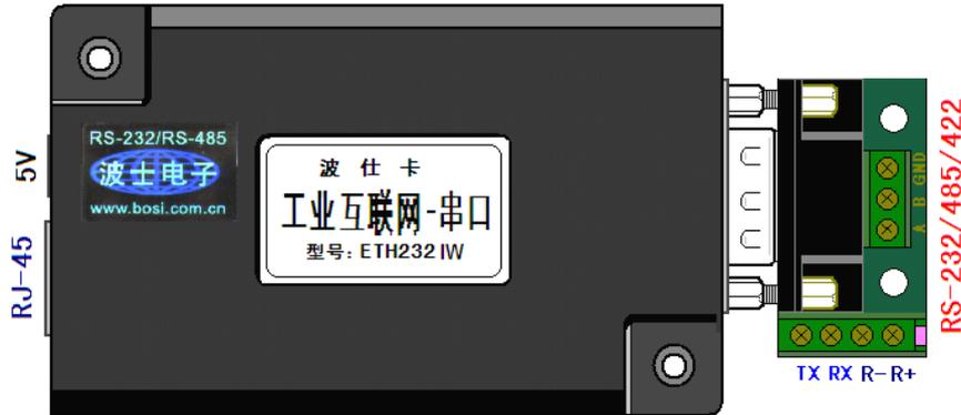
波仕 ETH232IW 型工业互联网/串口转换器实现通过互联网与 RS-232/485/422 串口的通信, 支持计算机、平板电脑以及智能手机。产品进行了重要的改进: 1. 采用了新的带安装孔的外壳、2. 工作范围温度达到工业级 $-40 \sim +85$ 度、3. 内置 2500V 光电隔离及 1000V 变压器隔离、4. 支持交叉线/直连线、5. 以太网升级到了 100M、6. 增加了简化版的虚拟串口软件。它具有超小型的外形 (80\*25\*55mm), 外插计算机网口或者 ADSL 猫的 LAN 口转换出 RS-232/RS-485/422, 还可以虚拟成为本地计算机串口, 支持串口透明传输。波仕 ETH232IW 是世界上唯一的工业互联网/串口转换器。波仕新一代专利产品, 谨防假冒! 专利号: 201120297328, 200630307752。
